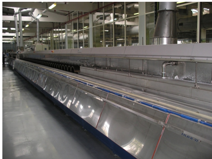
Bild 4.14 Salzbadanlage 1 Extruder, 2 Stahlband, 3 Wickler, 4 Salzschnmelze, 5 Kühlbad
